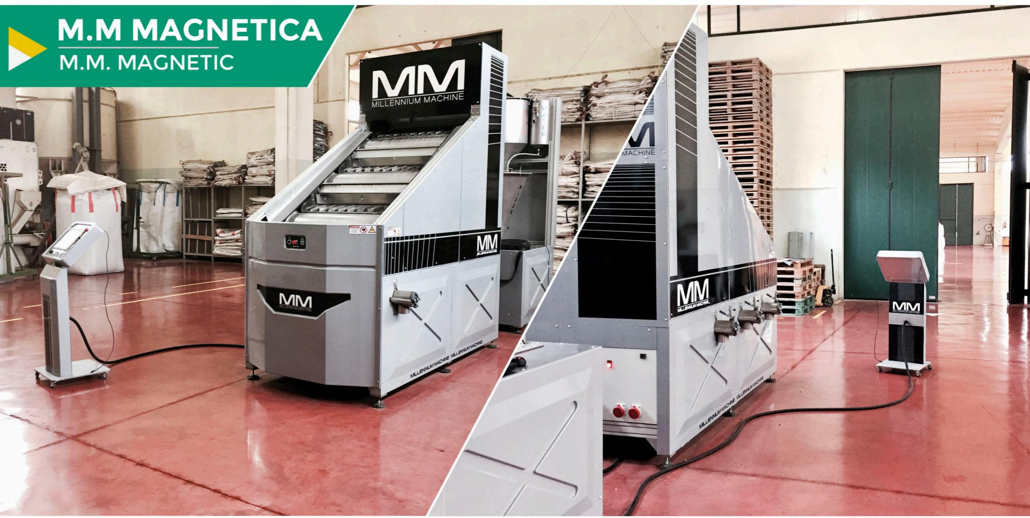
La **Millennium Machine (M.M.)** è stata progettata e realizzata dopo anni di studio e di estenuanti prove pratiche dove il confronto con altre macchine già esistenti è stato duraturo ed assiduo, fino a raggiungere un ottimo risultato: eliminare la cuscuta al 100% nel minor tempo possibile.
